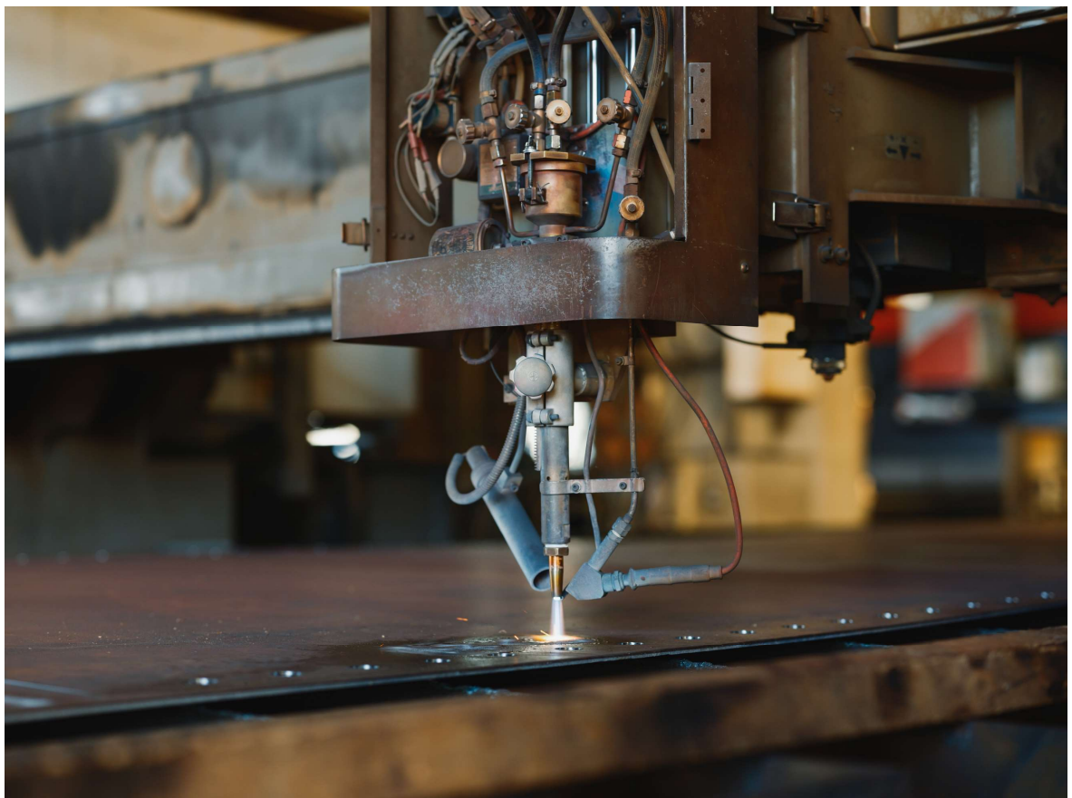
② CAD データをもとに加工機で自動切断（加工）
